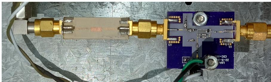
Figura 6.8: LNA y filtro pasa-banda del AFE.
