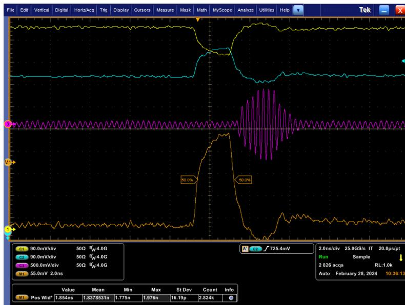
Figura 6.24: Pulso UWB capturado con el osciloscopio. Los canales 1 y 2 corresponden al pulso diferencial generado por la FPGA y el canal 3 a la salida del transmisor.
